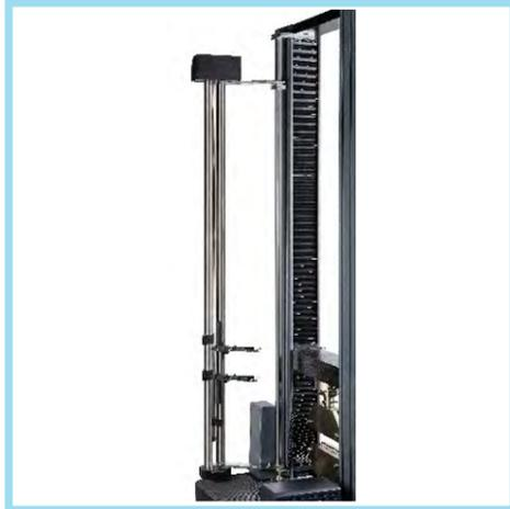
图1. 土工布伸长率测量装置
